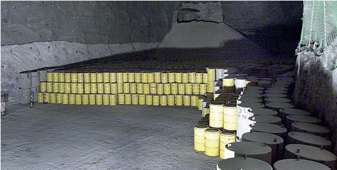
Dépôt souterrain de déchets nucléaires de faible et moyenne activité dans l'ancienne mine de sel de Morsleben (Allemagne), avril 2001 (site toujours en fonction)
