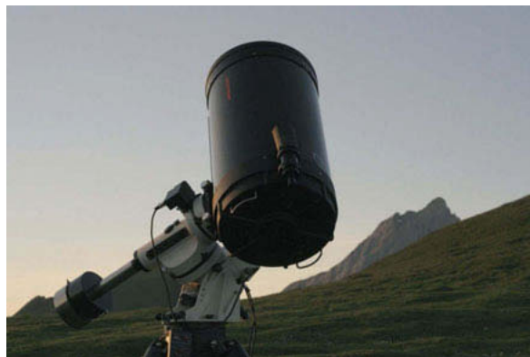
Télescope Schmidt-Cassegrain sur monture équatoriale allemande (Photo E. Beaudoin).
