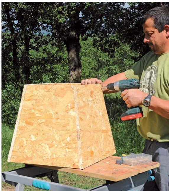
15 Assemblez le moule en vissant les côtés D sur les côtés E.
