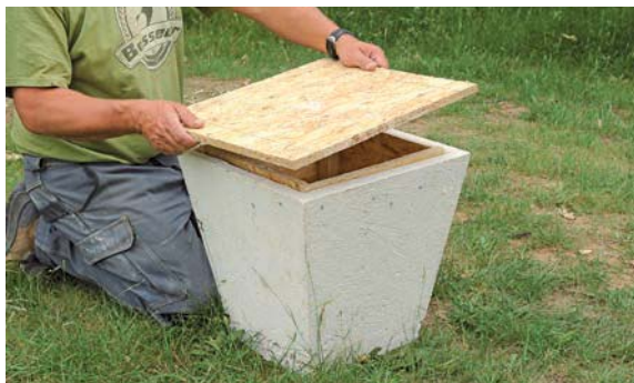
4 Le fond enlevé dégage le contre-moule.
