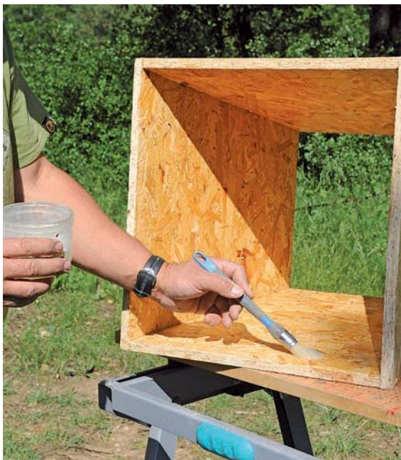
16 Enduisez abondamment l'intérieur et l'extérieur du moule d'huile ou de cire.
