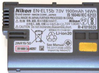
▲ Ici par exemple la date de fabrication est le 13/08/2018.
