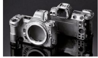
▲ Le châssis en alliage de magnésium des Z6 et Z7.
