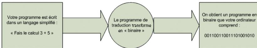
FIGURE 1.1 – Traduction d'un programme en langage binaire
