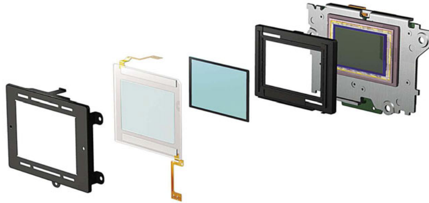
Capteur CMOS du D700, avec le filtre et la glace vibrante anti-poussières
