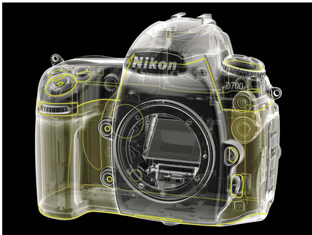
Vues fantômes du Nikon D700 : en jaune l'emplacement des joints anti-poussière et anti-humidité
