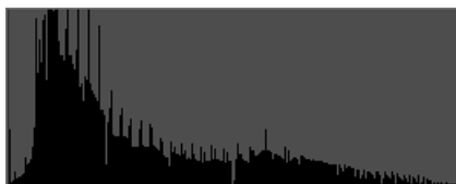
Fig. I-1 Histogramme en peigne. Les pics et les « trous » blancs sont caractéristiques d'une image dégradée par de multiples traitements.
