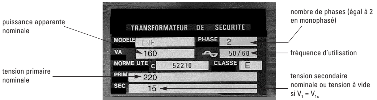
Fig. 2 – Plaque signalétique d'un transformateur abaisseur de tension.
