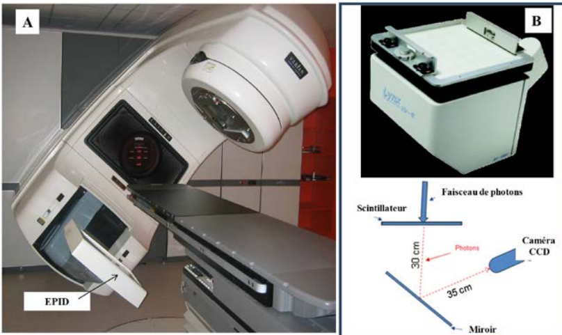
Figure I.1 Exemples d'EPID fixé sur l'accélérateur linéaire grâce à un bras rétractable : EPID aSi1000®-Varian [A] ou indépendant, Lynx®-IBA et Fimel (France) [B].
