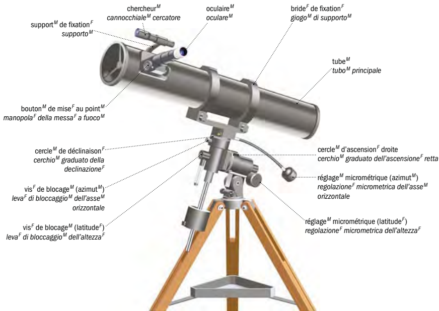
coupe F d'un télescope M sezione F di un telescopio M
