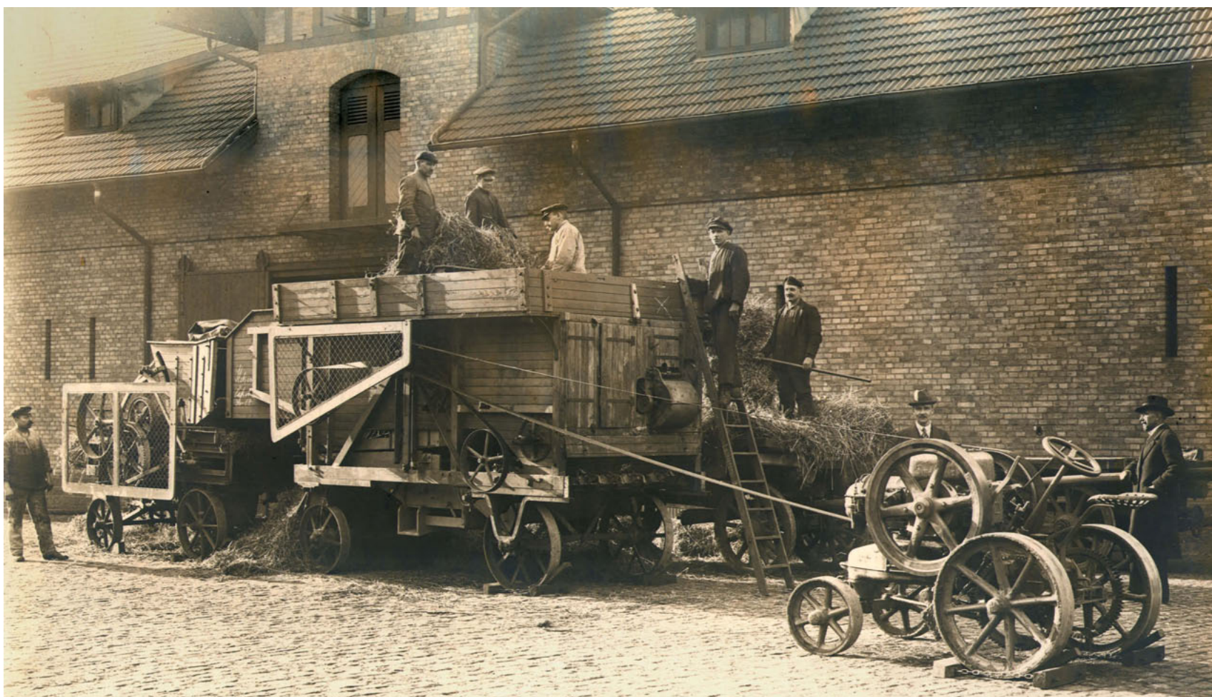
HL 12 prototype (roues avant à six rayons) entraînant une batteuse de belle taille et une presse.
