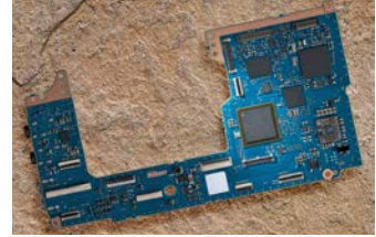
▲ La platine électronique et le processeur EXPEED du D750.
