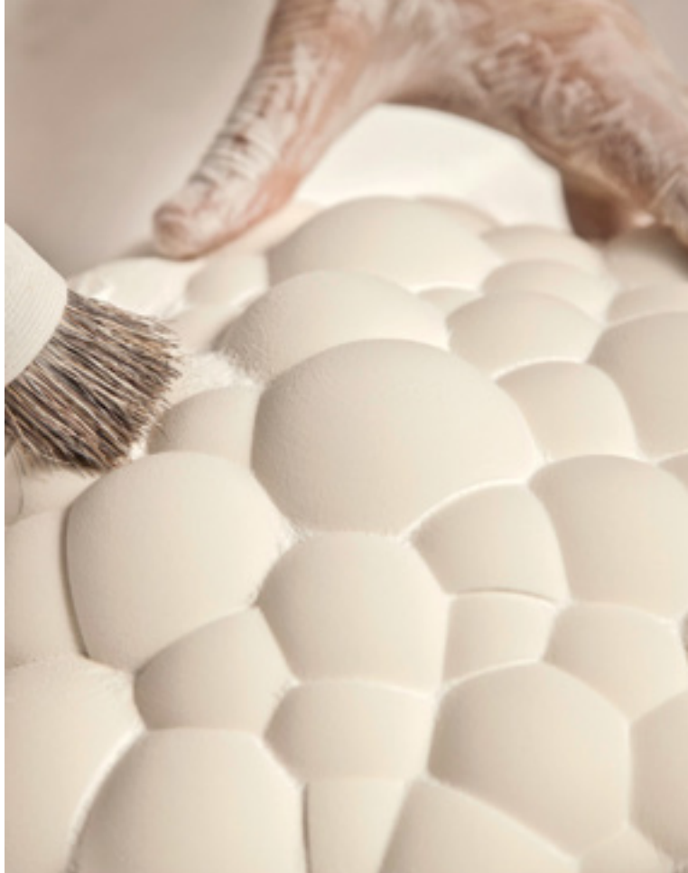
Postproduction après impression 3D de l'applique «Bolle» de la marque .exnovo (Italie), finition à la main pour enlever la poudre de nylon.
