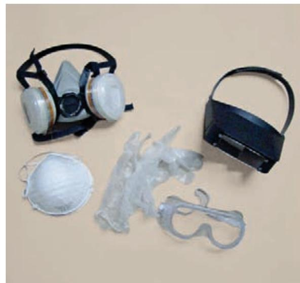
**Fig. 9** Dans la partie supérieure : un masque à solvants organiques (à gauche) et des lunettes loupes (à droite). Dans la partie inférieure (en partant de la gauche) : un masque à poussière, des gants résistant aux solvants et des lunettes de protection.
