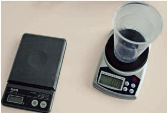
**Fig. 20** Matériel d'analyse : balance électronique avec tare permettant une remise à zéro.
