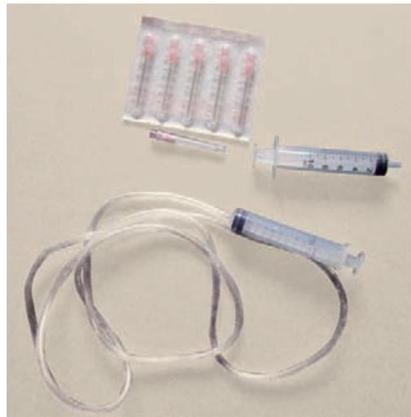
**Fig. 24** Seringues et tuyau à injection.
