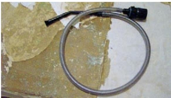
**Fig. 22** Kit micro-aspiration, l'embout situé à droite sur la photo se fixe sur le tube flexible de l'aspirateur, sur la gauche on observe la petite brosse permettant une micro-aspiration. En arrière-plan, le revers d'une peinture sur toile marouflée après dépose.
