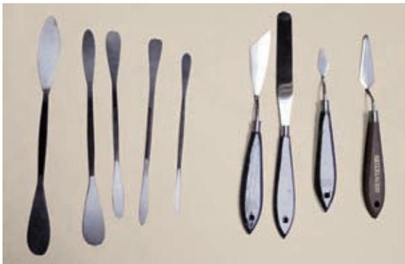
**Fig. 21** Petites spatules et petits couteaux à peindre. De gauche à droite, cinq spatules allant de la plus grande (largeur 2 cm) à la plus petite (largeur 0,4 cm) ; couteau à mélanger ; couteau à palette et deux couteaux à peindre n°4 et n°2.
