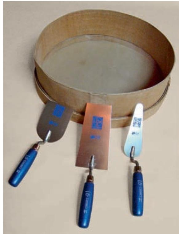
Fig. 17 Tamis et, de gauche à droite, truelles à mortier et truelle langue de chat.
