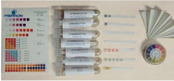
**Fig. 19** Matériel d'analyse in situ comprenant des bandelettes d'analyse des sels, du fer et du pH, ainsi que la fiche d'interprétation des bandelettes.
