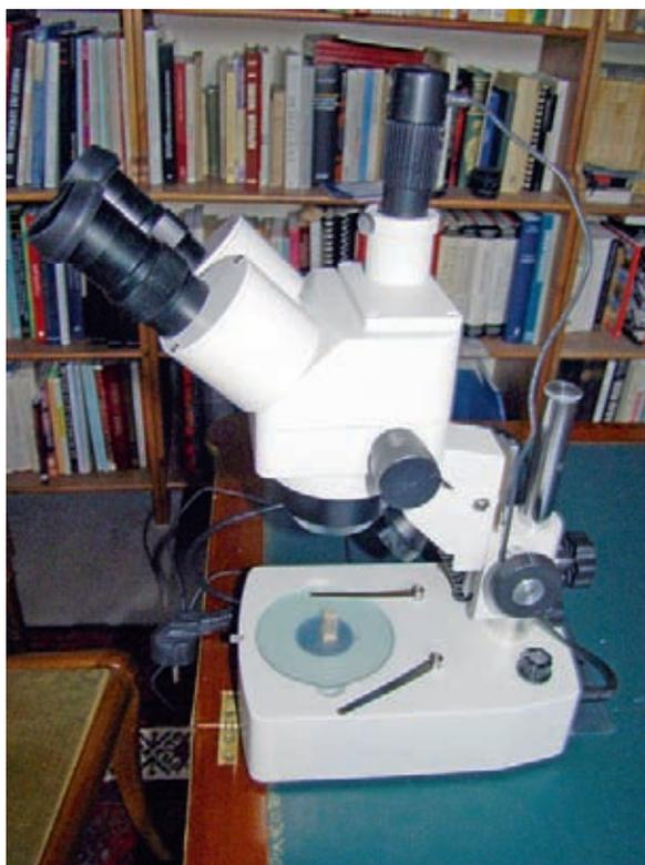
**Fig. 14** Vue d'un microscope électronique à grossissement de 30 à 200 fois avec prise de vue électronique.
