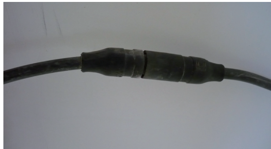
Connecteurs mal branchés susceptibles de produire des arc électriques.
