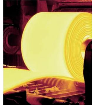
Laminage à chaud d'une bobine d'acier.
