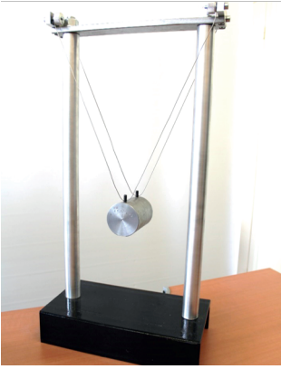
FIGURE 1.17. À droite : câble 1 et ses axes locaux. À gauche : pendule utilisé à l'université de Toulouse pour la calibration des accéléromètres © Christelle Tribout.
