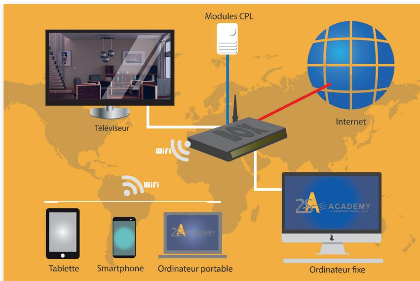
**Fig. 1-4** Schéma du réseau domestique
