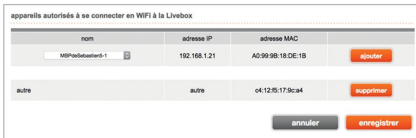
**Fig. 1-7** Option filtrage du matériel activée
