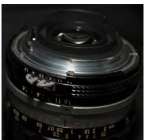
Figure 1-9 Objectif ancien transformé par le montage d'une bague AI dans les années 1980
