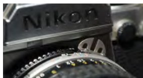
Figure 1-7 Couplage d'un objectif sur un appareil des années 1980 : la fourchette n'actionne plus aucun levier.
