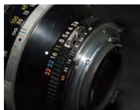
Figure 1-11 Objectif ancien modifié par meulage de la bague de diaphragme
