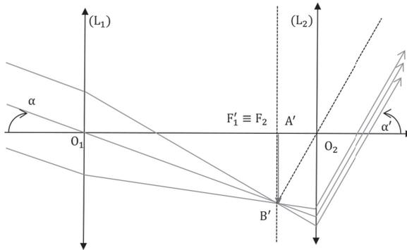
c. La pellicule doit être placée à l'endroit où se forme une image. Elle doit donc être placée dans le plan focal image de la lentille  $L_1$  (= plan focal objet de la lentille  $L_2$ ).
