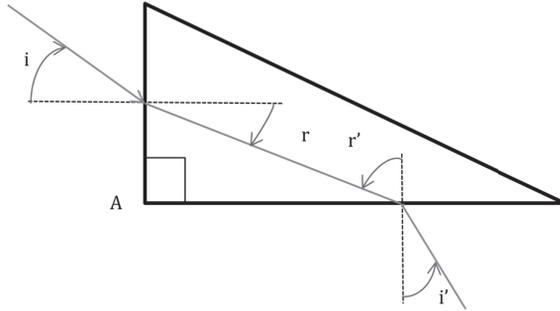
2. a. La deuxième loi de Snell-Descartes sur la réfraction de la lumière permet d'écrire pour la face d'entrée du prisme :
