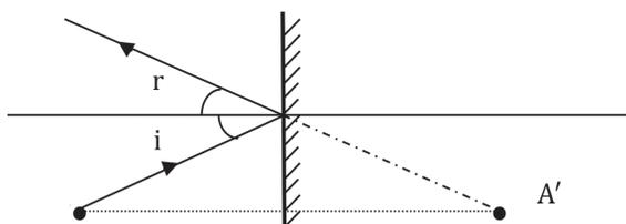
On utilise la deuxième loi de Snell-Descartes de la réflexion, l'angle réfléchi est égal à l'angle incident ( $i = r$ ). L'image  $A'$  est virtuelle.
