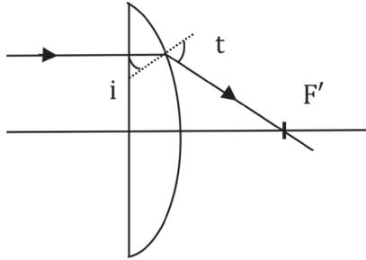
Le rayon incident à l'entrée de la lentille n'est pas dévié (incidence normale). À la sortie de la lentille, le rayon passe d'un milieu plus réfringent à un milieu moins réfringent ; il s'écarte donc de la normale (conséquence de la deuxième loi de Snell-Descartes pour la réfraction :  $t > i$ ).
