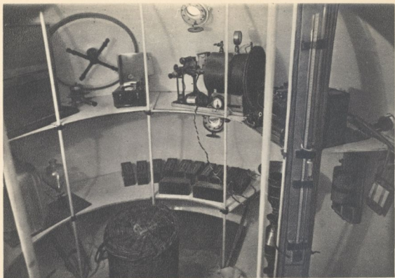
Vue plongeante dans la cabine, avant la première ascension. (Par terre, un panier formant siège ; premier étage : batterie Helleesen ; second étage : divers instruments électriques ; à gauche : l'un des trous d'homme ; au milieu : un hublot ; à droite : baromètre à mercure.)
