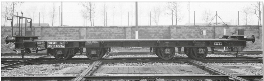
Wagon plat Sujf 42002 de la Compagnie de l'Est à quatre essieux de la série construite en deux exemplaires en 1940 par CFMCF.
