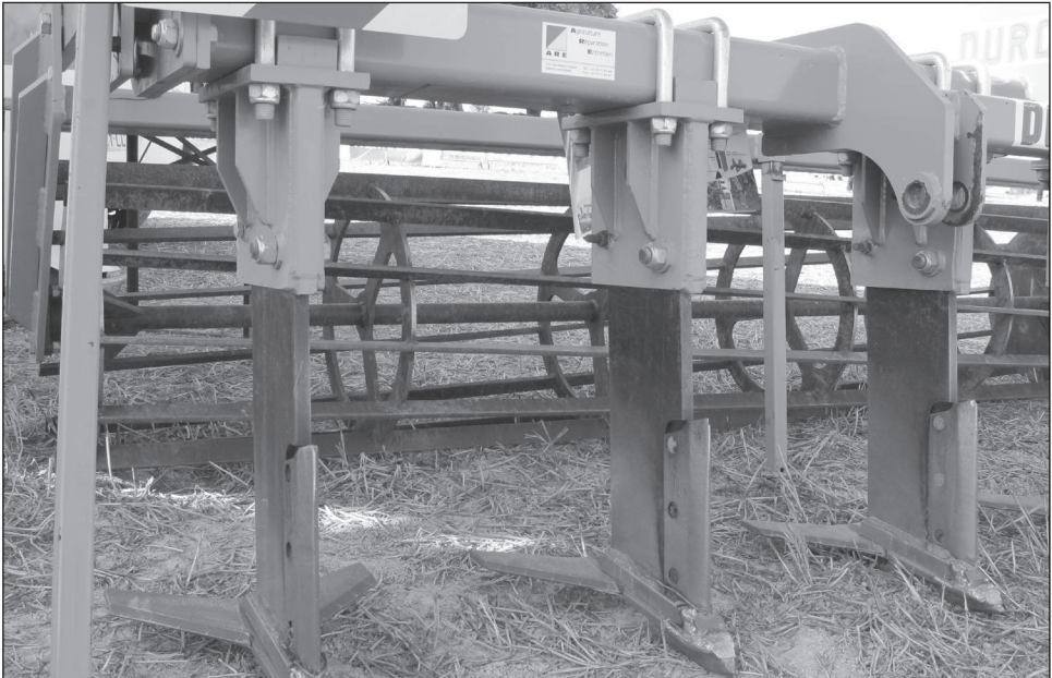
Photo 8.2: Sous-soleuse à dents droites à profil conventionnel (Duro)
