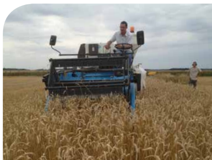
Photo 87. Récolte des microparcelles avec une moissonneuse-batteuse expérimentale - Ferme d'Orvilliers.
